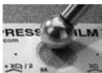
y frote en sentidos transversales para producir una réplica con un aspecto de uniforme. Normalmente se requieren de 30 a 60 segundos para comprimir completamente todas las partes
