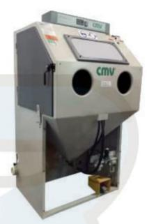
sin riesgo de impacto de abrasivo, y una perfecta iluminación que en conjunto con el sistema extractor de polvo, garantiza la buena visibilidad del operario para el manejo de las diferentes piezas a tratar.
